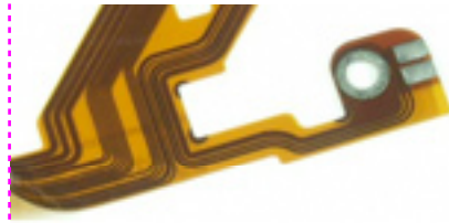
Flex circuit (Kapton™ polyamide)
